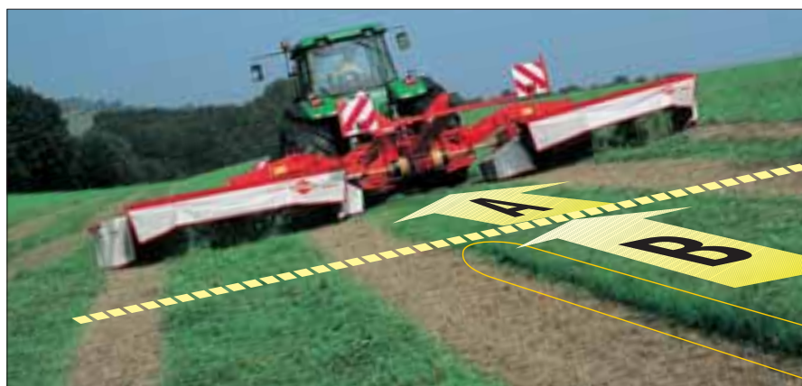
A: Mit Seitenversatz kommt es zu keinen ungemähten Futterstreifen. B: Ohne Seitenversatz sind trotz der großen Überlappung zwischen der vorderen und den hinteren Mäheinheiten ungemähte Futterstreifen erkennbar.
