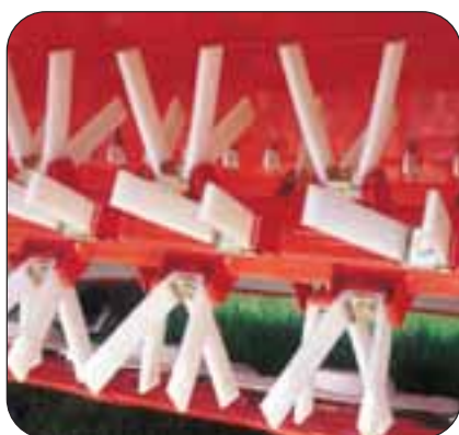
Aufbereiterrotor mit elastischen Fingern (FC 313 F)
