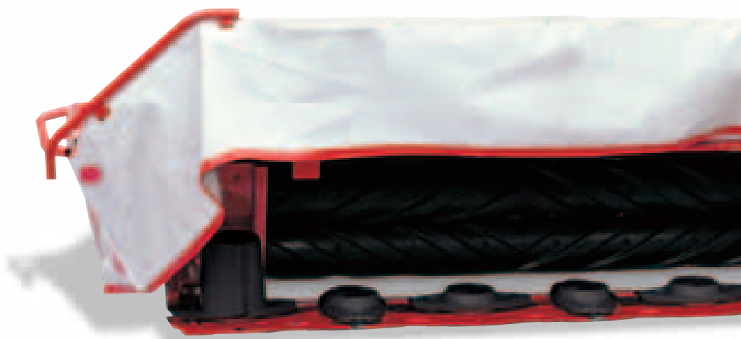
(Aus Gründen der besseren Darstellung ist die Maschine auf dem Foto in der "Arbeitsstellung" abgestellt zu sehen. Die Maschine ist jedoch aus Sicherheitsgründen grundsätzlich in der "Transportstellung" abzustellen).
