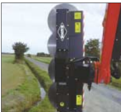
Schneidkopf mit 4 Sägeblätter ø 650 mm zum Entasten von Baumstämmen
