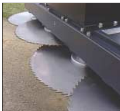
Schneidkopf mit 4 Sägeblätter ø 650 mm zum Entasten von Baumstämmen
